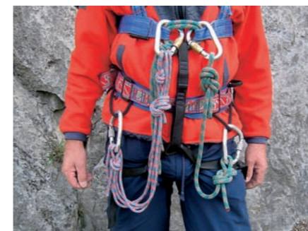
Zweifelhaftes „Klettersteig-Provisorium“ mit Brust-/Sitzgurt-Kombination, zerrissener Sitzgurt.
